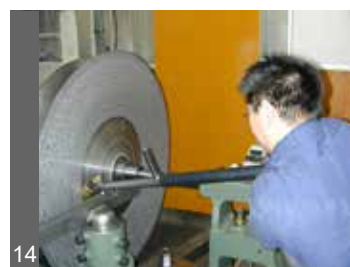
写真14 スピニングマシンによる絞り加工
