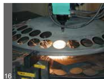
写真16 三次元レーザー加工機による穴加工
