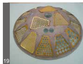
写真19 製品写真 三角治具をコーティングドームに配置した状態
