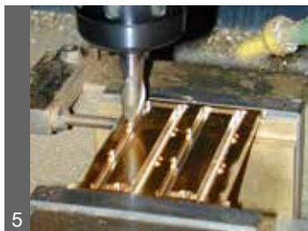
写真5 マシニングセンタによる加工※
