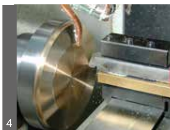
写真4 旋盤による加工
